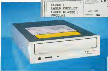
Das Sony CDU 611-10 bietet wie einige andere Laufwerke eine Beschreibung der Anschlußbelegung auf dem Gehäuse.
